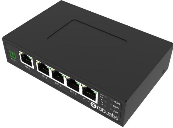
R2111 是鲁邦通新一代 5G 路由器，支持 5G 网络，支持双 SIM 卡备份以及 5 个千兆以太网端口，能满足物联网中多网口应用场景的需求，为物联网设备和传感器提供高带宽、低时延、高可靠的无缝无线网络连接。
